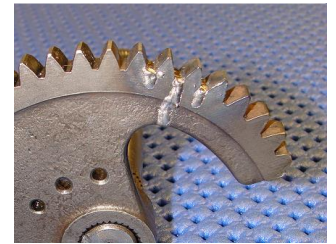
DKW Zahnradachse Riss vorher lasergeschweißt
