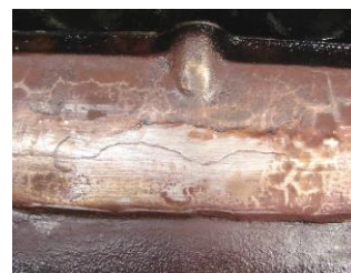
Riss im 8-Zylinder Motor
