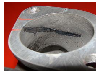
Riss innenseitig lasergeschweißt
