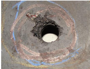
Flugzeug Cessna 172, Baujahr 1973, Ölwanne Korrosion Innenseite innenseitig lasergeschweißt
