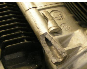
Ausbruch am Ducati Motor Motorrahmenverbindung
