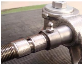
Mercedes SL 300, Hinterachslager lasergeschweißt
