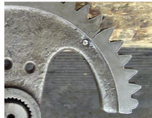
DKW Zahnradachse Riss vorher lasergeschweißt
