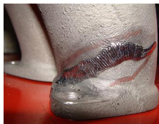
Riss außenseitig lasergeschweißt
