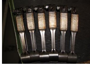
Mercedes SSK Steuerhebel lasergeschweißt
