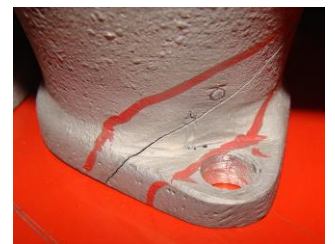
Riss innenseitig lasergeschweißt
