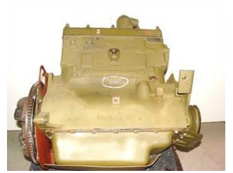
Motor mit Frostschaden
