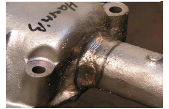
Auspuffkrümmer Riss vorher lasergeschweißt
