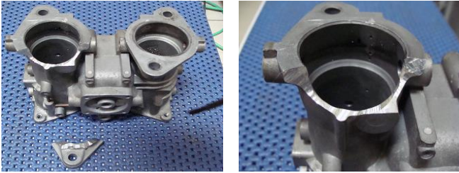
Mercedes 190 SL Vergaser lasergeschweißt
