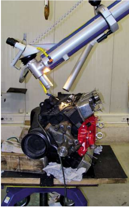
▲ Bild 2. Ausgebauter 5,7-L-Motor „350cui small block“ in Arbeitsposition unter der Bearbeitungsoptik des Nd:YAG-Laserstrahlschweißgeräts
