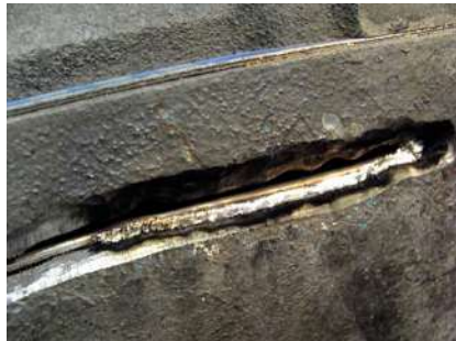
▲ Bild 8. Begonnenes Anschweißen der Badsicherung aus Nickel an den Grauguss
