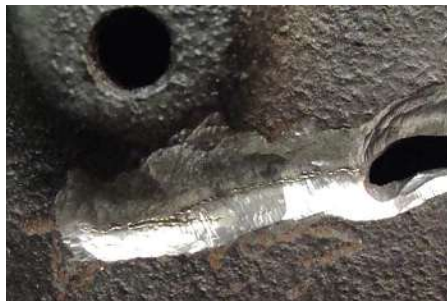
▲ Bild 6. Mit dem Laserstrahl links und rechts vom Haupttrissende sichtbar gemachte Haarrisse
