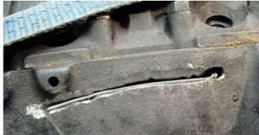
► Bild 7. Als Badsicherung in den ausgearbeiteten Riss eingelegter 3-mm-Nickeldraht
