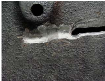
▲ Bild 5. Links und rechts vom bis in den Wassermantel ausgeschliffenen Haupttriss wurde ausgenutzt, um den Haarrissverlauf ermitteln zu können.
