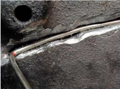
► Bild 7. Als Badsicherung in den ausgearbeiteten Riss eingelegter 3-mm-Nickeldraht
