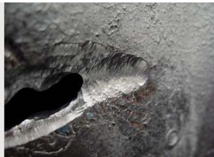
▲ Bild 5. Links und rechts vom bis in den Wassermantel ausgeschliffenen Haupttriss wurde ausgenutzt, um den Haarrissverlauf ermitteln zu können.
