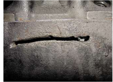
▲ Bild 4. Der mit bloßem Auge an Rost- und Kalkspuren erkennbare sichtbare Riss (links) wurde mit einem 3-mm-Fräser ausgearbeitet (rechts)
