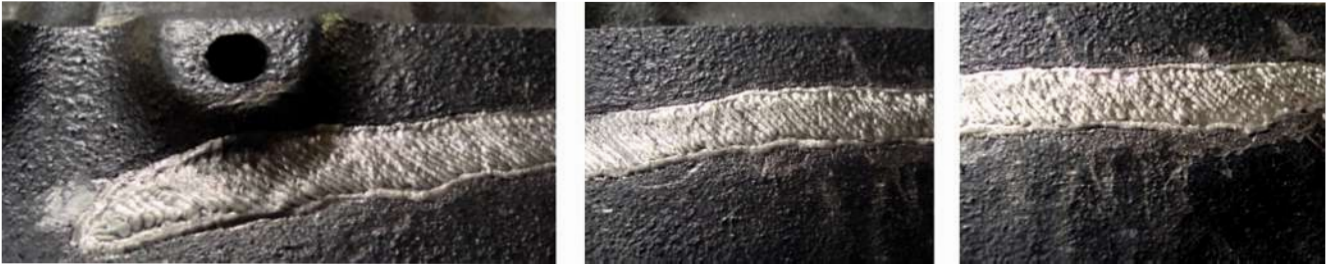
▲ Bild 11. Abschließend erhält der Übergang Schweißnaht-Grauguss umlaufend eine schmale Schweißbraupe.
