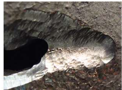
▲ Bild 6. Mit dem Laserstrahl links und rechts vom Haupttrissende sichtbar gemachte Haarrisse
