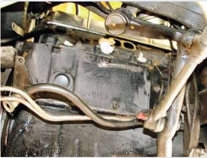
▲ Bild 14. Eingebauter Motor, bereit für die Reinigungsspülung.
