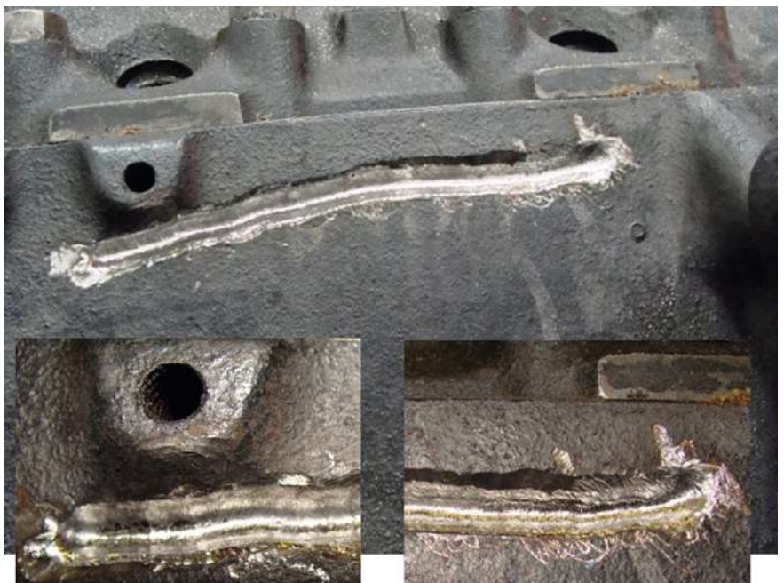
▲ Bild 8. Begonnenes Anschweißen der Badsicherung aus Nickel an den Grauguss
