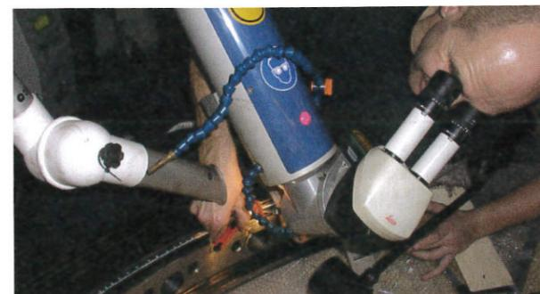
Abb. 19: Detail Laserauftragschweißung
