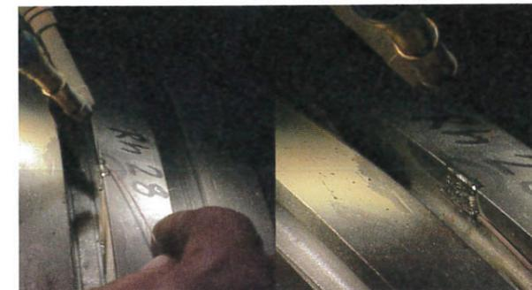
Abb. 22: Reparaturzone während (links) und nach (rechts) der Laserschweißung
