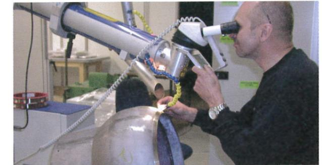
Abb. 34: Manuelles Auftragschweißen mit Laser der Fehlstelle am Übergang vom Grundwerkstoff GS-17CrMoV5.11(1.7706) zur Dichtsitz-Auftragung aus Stellite 6
