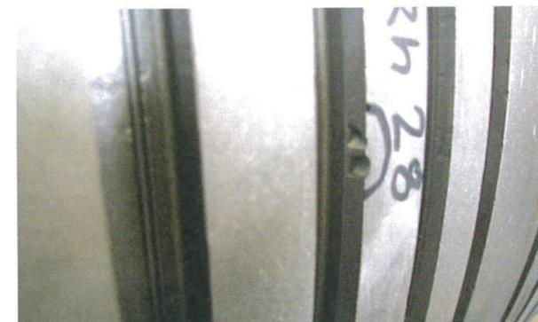
Abb. 20: Reparaturzone an einem Turbinenläufer
