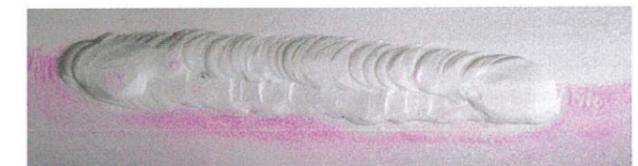
Abb. 35: Reparierte Übergangszone Dichtsitz-Grundwerkstoff mit Schweißgut NiCr20Mn3Nb (2.4806)
