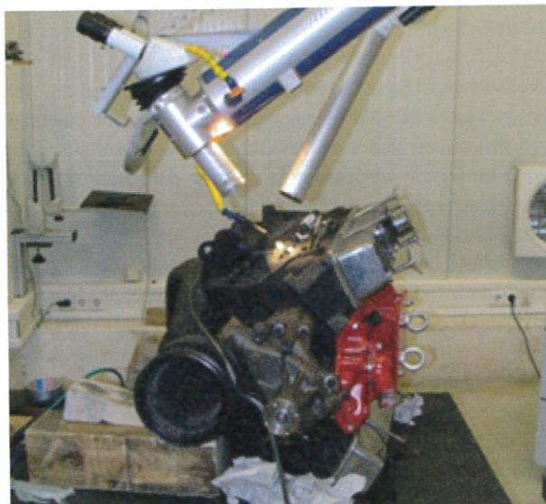
Abb. 7: Motorblock und Laseranlage in Arbeitsposition
