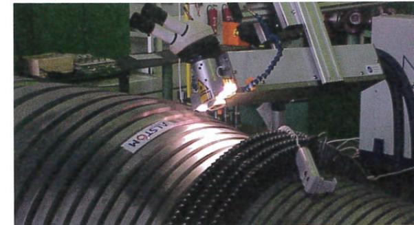
Abb. 21: Vorbereitung zur Laserschweißung
