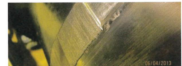
Abb. 26a: Auftragsschweißgut in der ausgefrästen Schadzone
