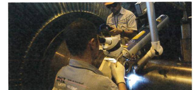
Abb. 25: Laserschweißer im Einsatz (mehrschichtig)
