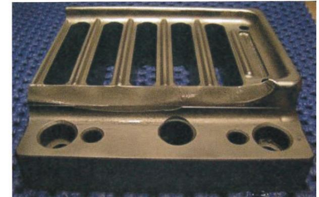
Abb. 4: Schnittmatrize mit ausgebrochener Kante
