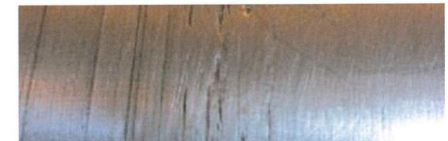
Abb. 24a,b: Beschädigung eines Wellenzapfens durch Riefen
