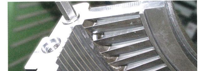
Abb. 12a: Turbinenleitrad mit örtlicher Beschädigung
