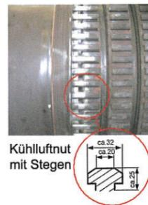
Abb. 29: Stegprofil zur Neuverbindung
