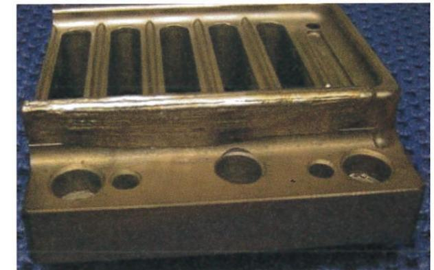
Abb. 5: Ohne Formabweichung repariertes Werkstück mittels 20 cm<sup>3</sup> Laser-Schweißgut
