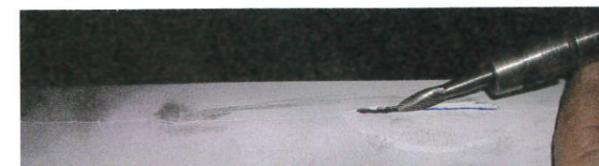
Abb. 33: Ausarbeiten einer Fehlstelle
