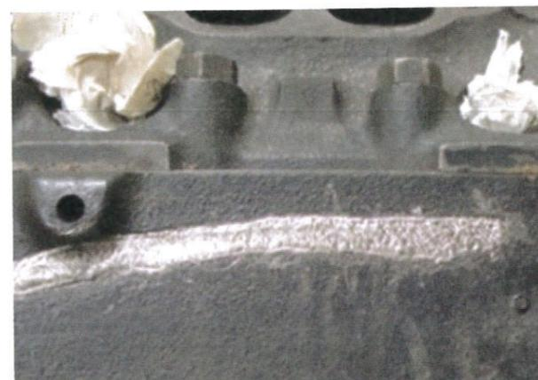
Abb. 9: Fertig aufgebaute Schweißnaht. Nahtoberfläche ist eben und entspricht der originalen Wandstärke des Motorblocks.
