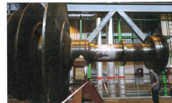
Abb. 23: Wellenzapfen eines ND-Läufers mit Beschädigungen
