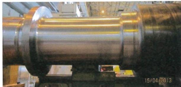
Abb. 27: Wellenzapfen, geschliffen/einbaufertig
